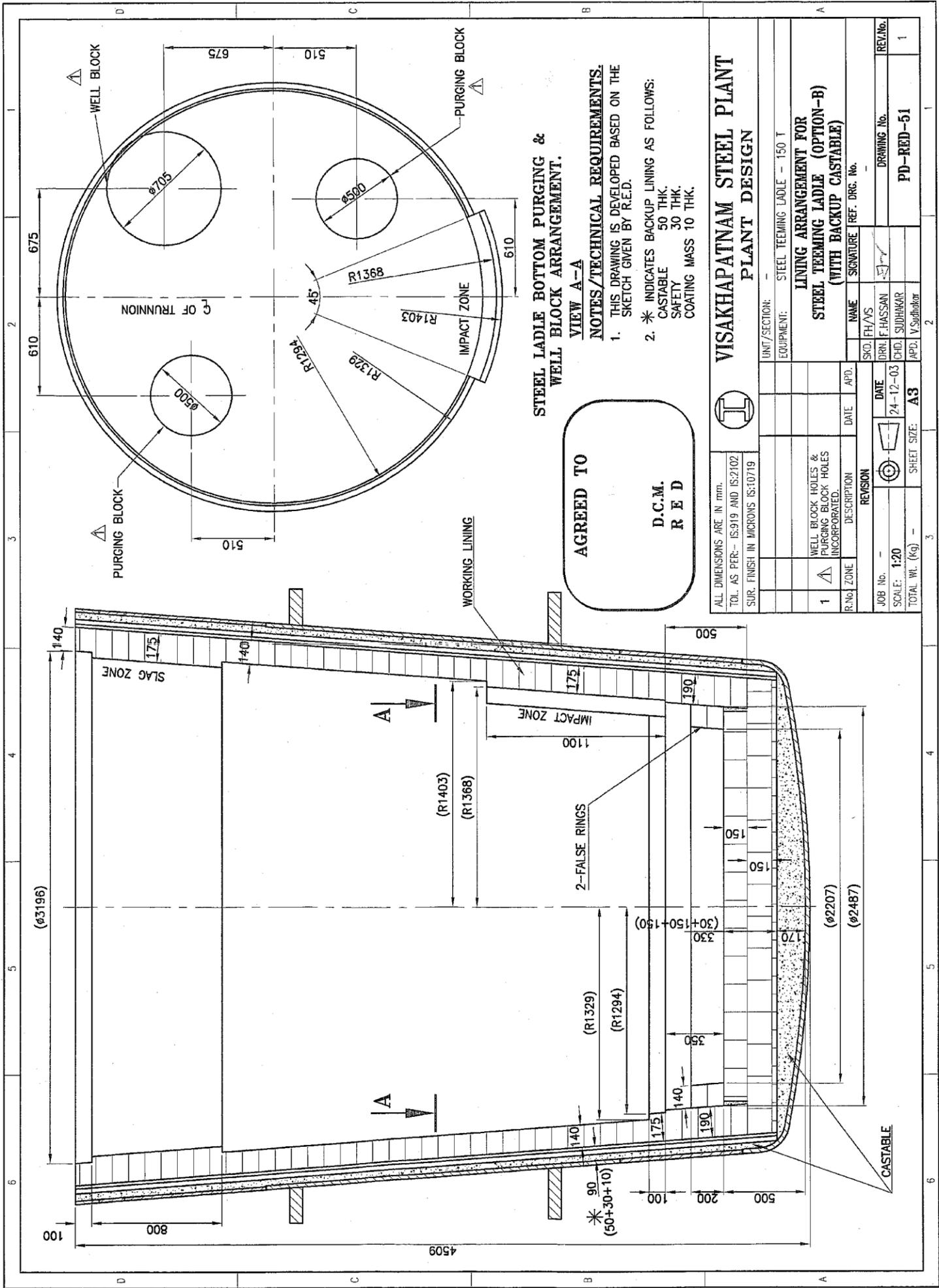
**STEEL LADLE BOTTOM PURGING & WELL BLOCK ARRANGEMENT.**
